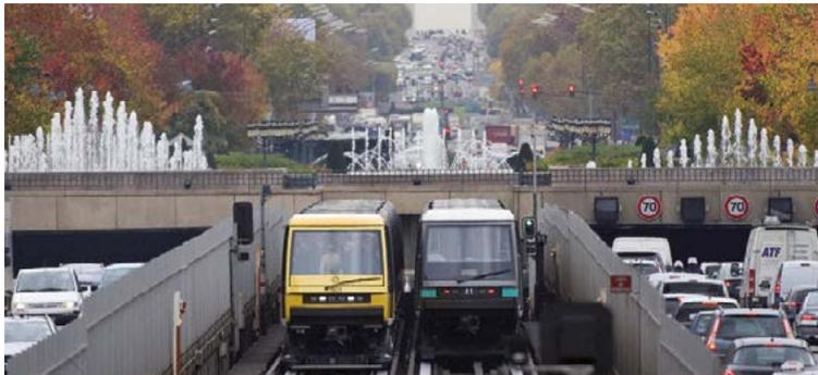
Équipées de pneus, les rames de la ligne 1 accélèrent et ralentissent plus rapidement que des rames avec des roues en fer (ce qui permet de rouler à 30 km/heure en moyenne). Les voyageurs y gagnent aussi en stabilité et en confort acoustique.
