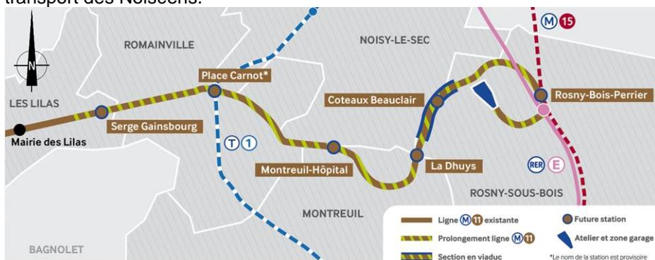
Figure 23 : schéma du prolongement de la ligne 11 du métro - Source : prolongementligne11est.fr
