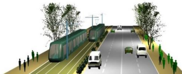
Figure 39. Vue d'un site propre unilatéral
