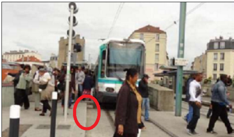
La marge existant pour l'allongement du matériel roulant est cerclée en rouge.
