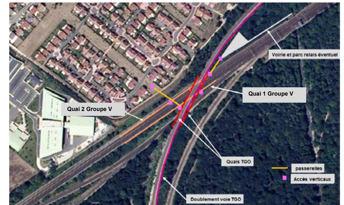
Figure 64 : Schéma d'organisation variante 1 - Station TGO sur le pont
