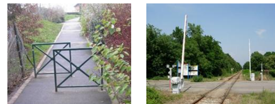
Figure 82 : Barrières disposées en chicane / demi-barrières équilibrées
