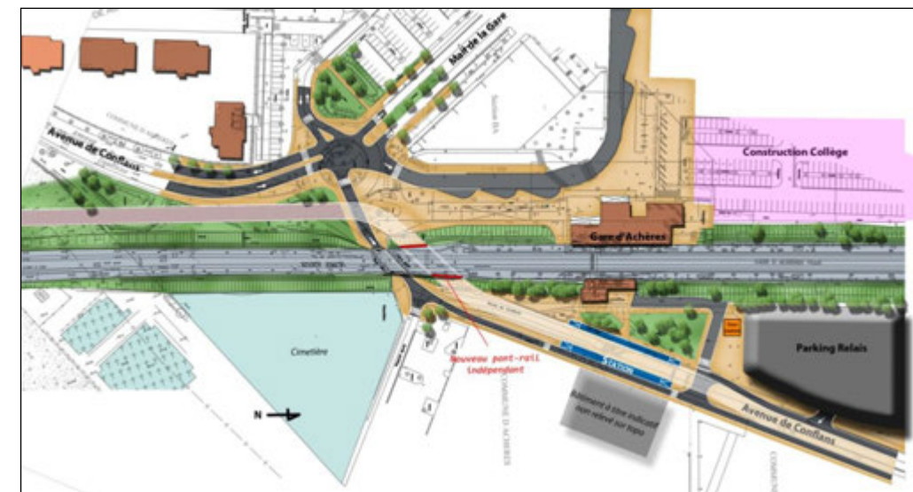
Figure 77 : Variante B1 - Station tram-train positionnée à l'Est, au droit de la sortie de la gare d'Achères avec création d'un nouvel ouvrage de franchissement des voies indépendant de celui existant
