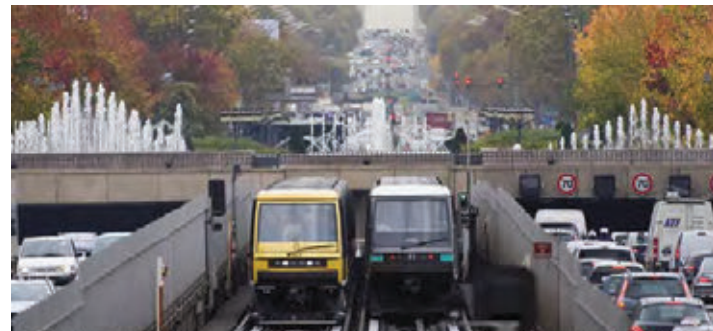
Équipées de pneus, les rames de la ligne 1 accélèrent et ralentissent plus rapidement que des rames avec des roues en fer (ce qui permet de rouler à 30 km/heure en moyenne). Les voyageurs y gagnent aussi en stabilité et en confort acoustique.
