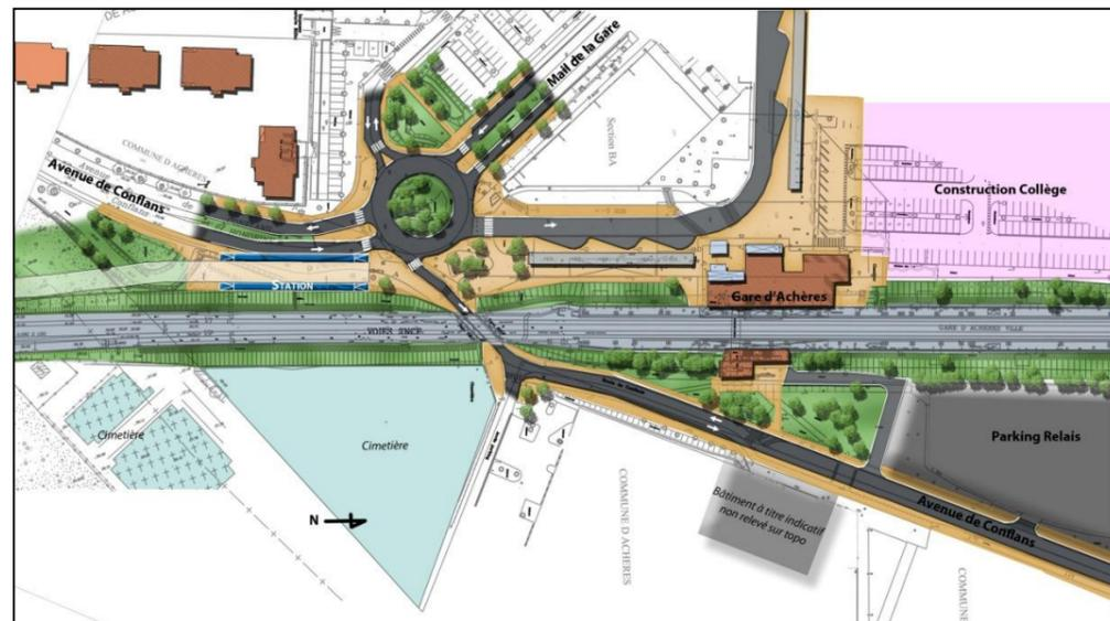
Figure 23 : Variante A2 - Station tram-train positionnée à l'Ouest, avant le carrefour
