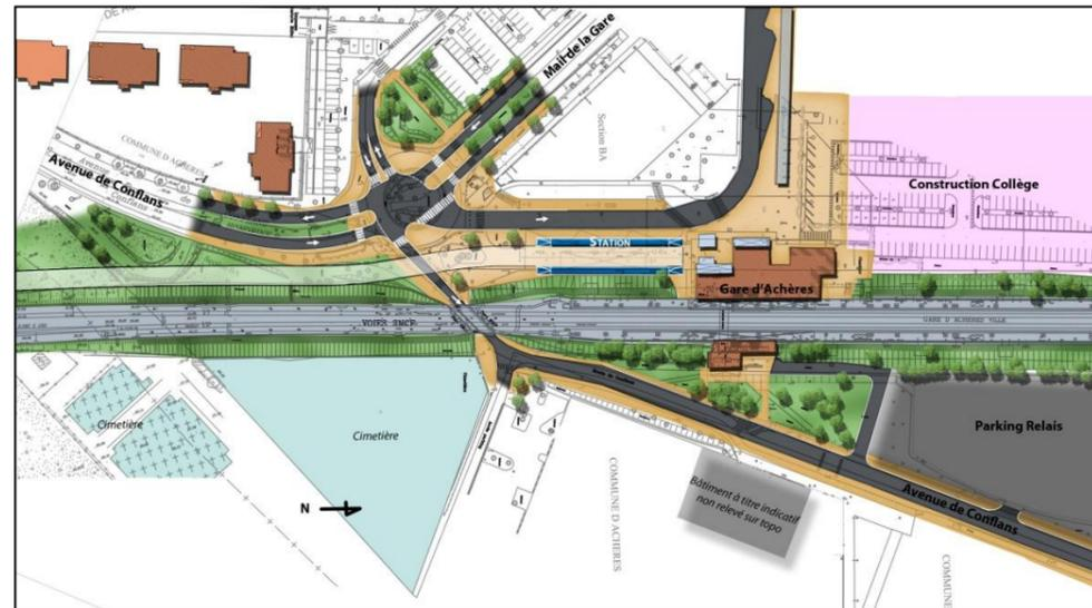
Figure 21 : Variante A1 - Station tram-train positionnée à l'Ouest, au droit de la gare d'Achères, avec quais latéraux
