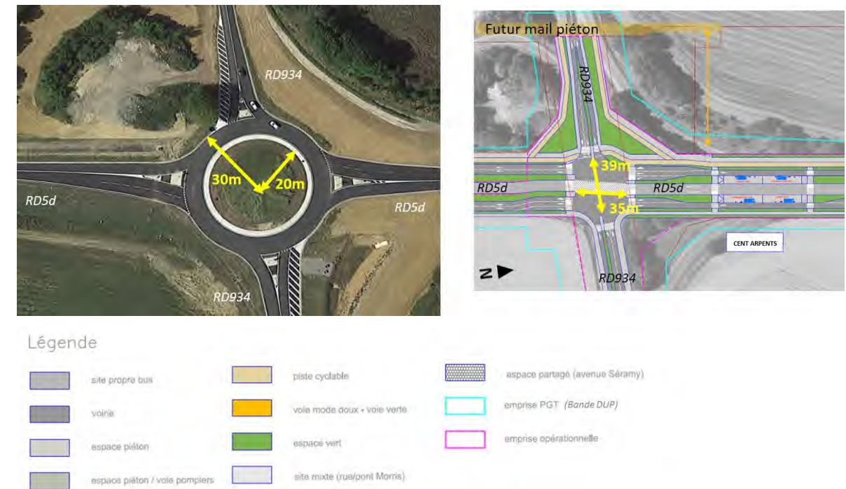
Figure 141 : Reconfiguration du carrefour Q proposée dans le cadre du projet de TCSP EVE - Plan d'intention (SOURCE : GROUPEMENT EGIS/ GAUTIER-CONQUET, 2020)
