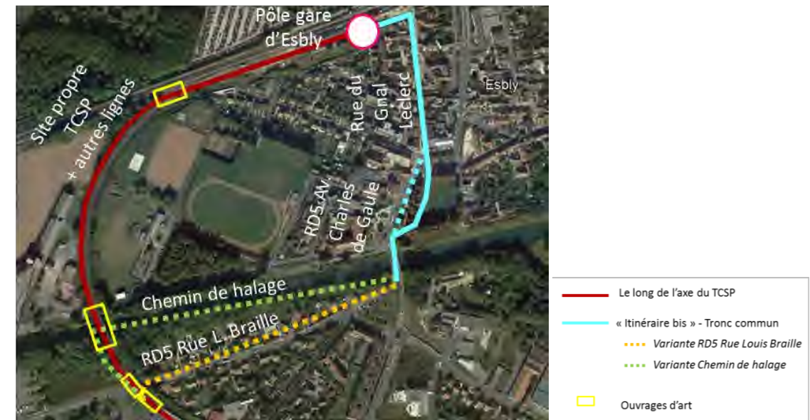
Figure 186 : Variantes de de cheminements cyclables étudiées dans le secteur d'Esbly entre la gare et le collège
