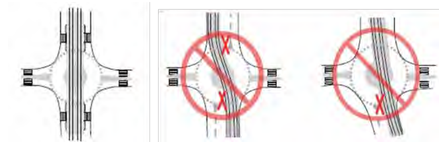
Figure 193 : Schéma d'insertion d'un TCSP dans un giratoire
