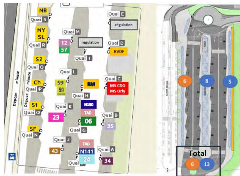
Figure 75 : Gare routière Nord de Marne-la-Vallée – Chessy dans sa configuration actuelle et affectation de lignes en gare routière de Chessy (bas)
