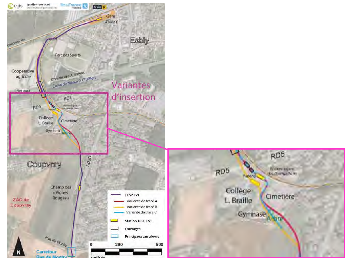
Figure 179 : Variantes de tracé étudiées dans le secteur d'Esbly – Insertion du tracé sur des secteurs hors voirie existante
