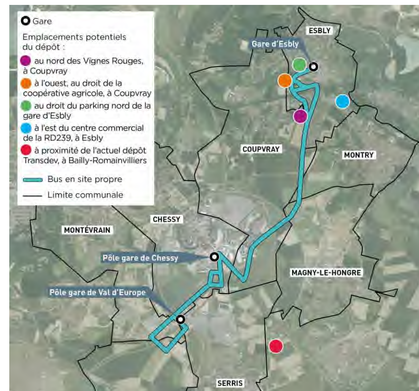
Figure 102 : Rappel des variantes de localisation du SMR du projet de TCSP EVE présentées en concertation (SOURCE : BILAN DE CONCERTATION, ÎLE-DE-FRANCE MOBILITES, 2015)
