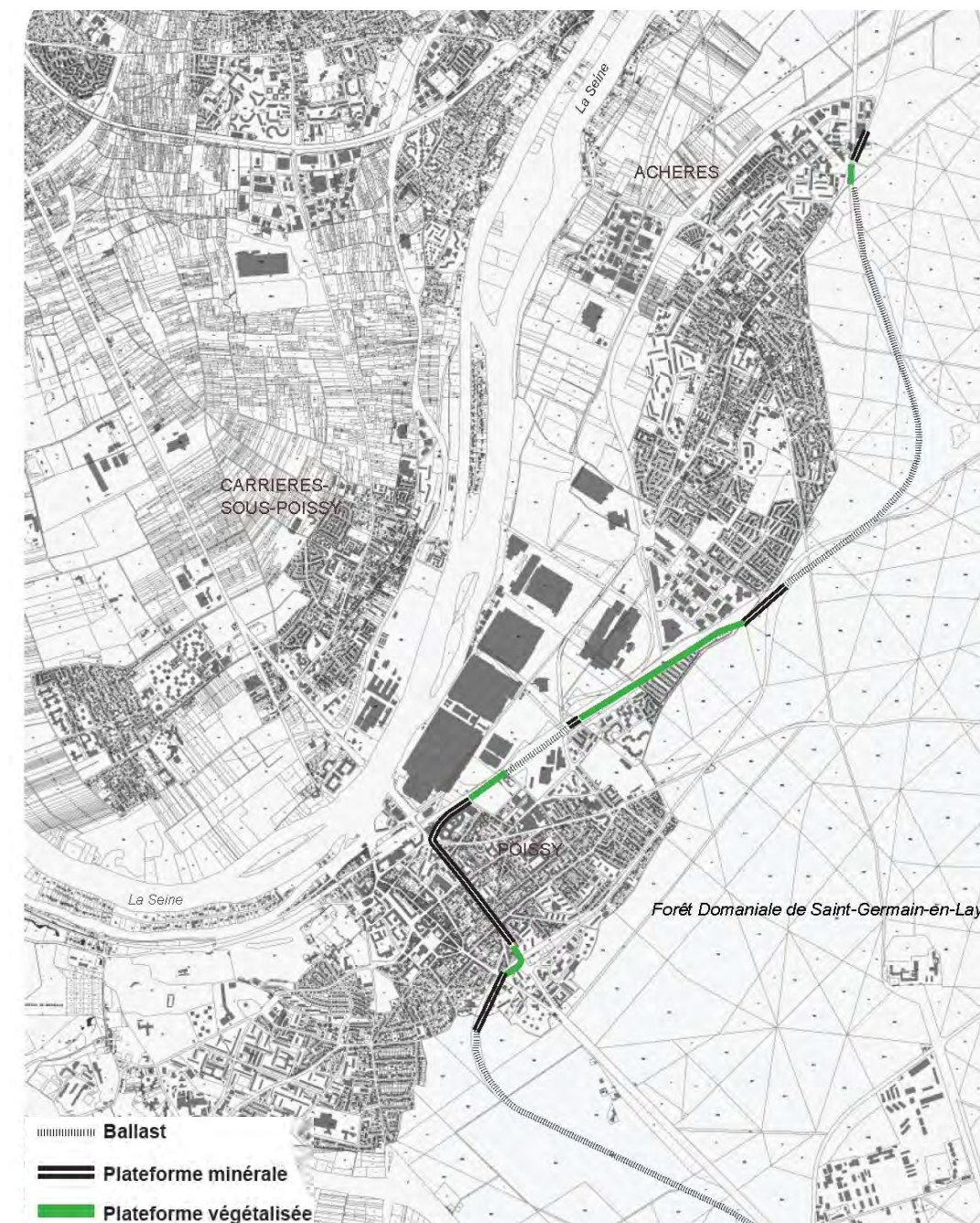
Figure 78 : Principe de revêtement sur le projet Tram 13 express Phase 2
