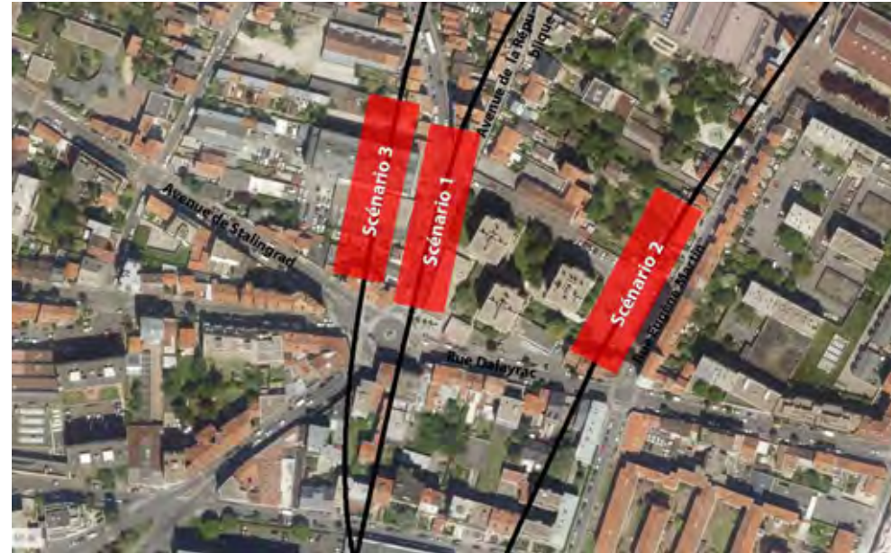
Figure 21 : Variantes de positionnement de la station Les Rigollots – stade schéma de principe
