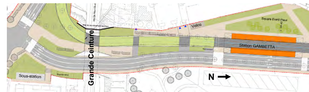
Figure 144 : Insertion de principe en site propre sous l'ouvrage
