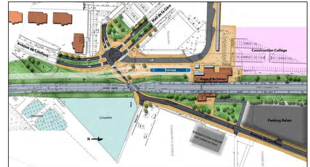
Figure 164 : Variante A1 bis - Station tram-train positionnée à l'Ouest, au droit de la gare d'Achères, avec quai central
