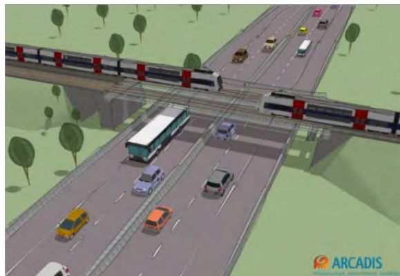
Figure 195 : Principe de Pont-rail
