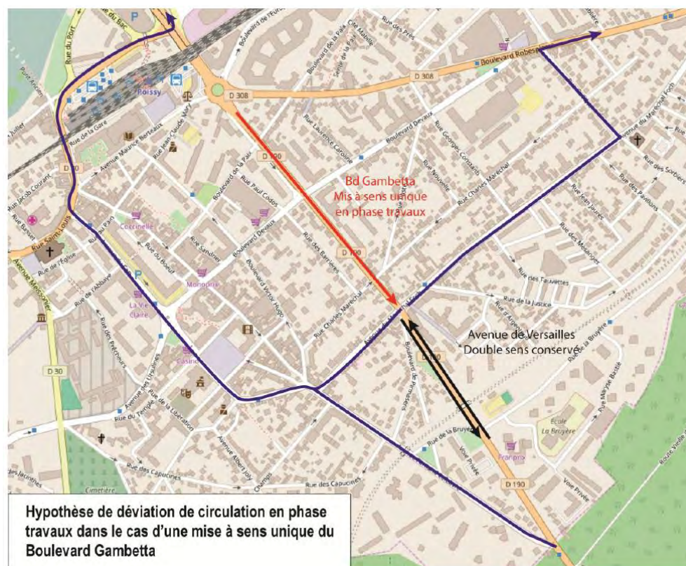
Figure 242 : Schéma de principe sur la gestion de la circulation en phase travaux sur l'avenue Gambetta
