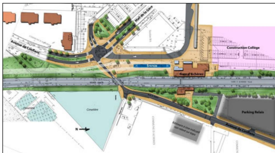
Figure 45 : Variante A1 bis - Station tram-train positionnée à l'Ouest, au droit de la gare d'Achères, avec quai central
