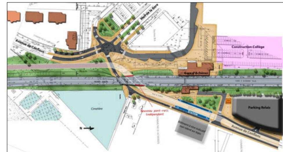
**Figure 47 : Variante B1 - Station tram-train positionnée à l'Est, au droit de la sortie de la gare d'Achères avec création d'un nouvel ouvrage de franchissement des voies indépendant de celui existant**
