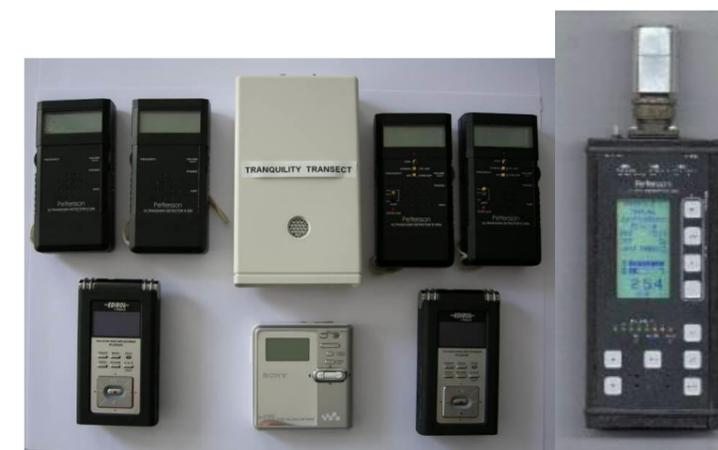
Figures 2 et 3 : Détecteurs-amplificateurs d'ultrasons et enregistreurs numériques utilisés lors de l'étude
