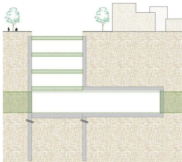
Phase 6 : Passage du tunnelier puis réalisation des dalles intermédiaires et enlèvement des butons provisoires
