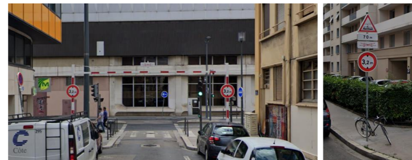
Figure 30 - Exemple de portique G3 accompagné d'un panneau B12 (cours Lafayette à Lyon)
