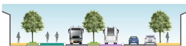
Figure 6 : Site propre monodirectionnel (Source Egis, 2023)
