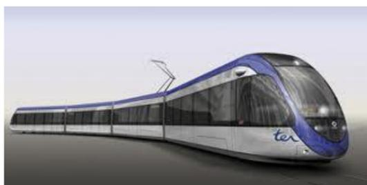
Figure 1 : Matériel roulant envisagé : le tram-train de type Dualis d'ALSTOM
