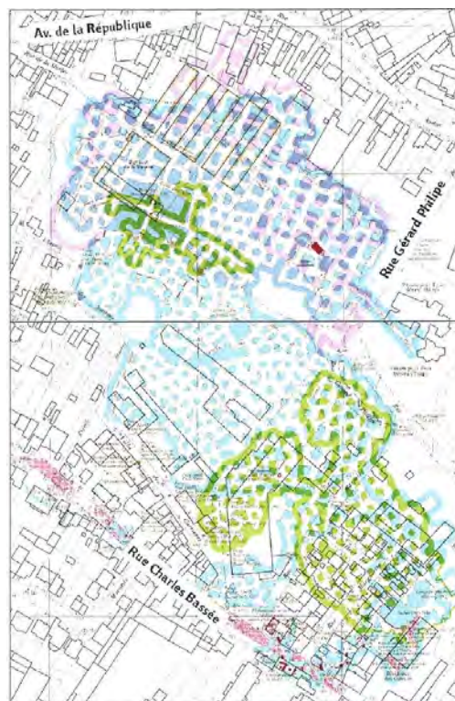
Figure 16 : Une zone de carrières en trois étages superposés
