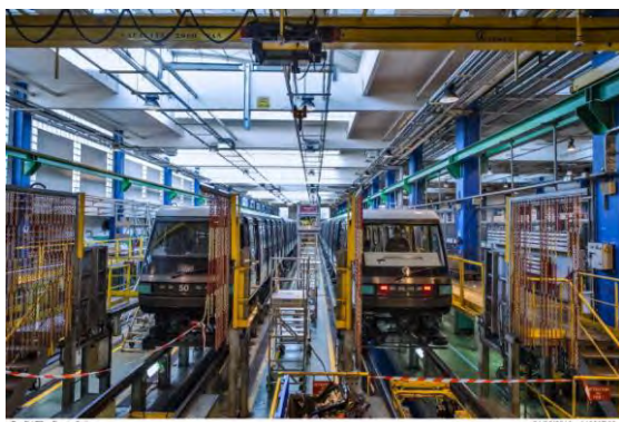
Figure 10 : L'atelier de maintenance patrimoniale (AMP) de Fontenay-sous-Bois (à droite, maintenance des batteries)
