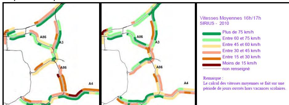
Figure 34 : Vitesses moyennes de circulation sur le réseau autoroutier lors de la pointe du matin, entre 7h et 8h, et du soir, entre 17h et 18h
