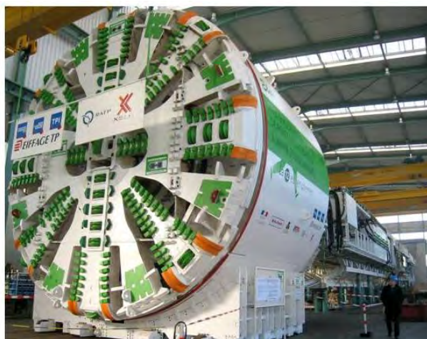
Figure 53 : Tunnelier « Elodie » de la ligne 12
