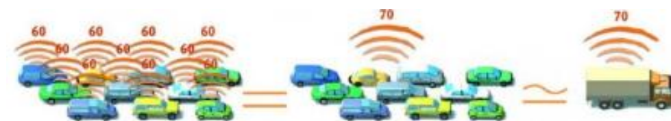
Figure 343 – Addition de 10 sources sonores de même intensité (Source : Bruitparif)
