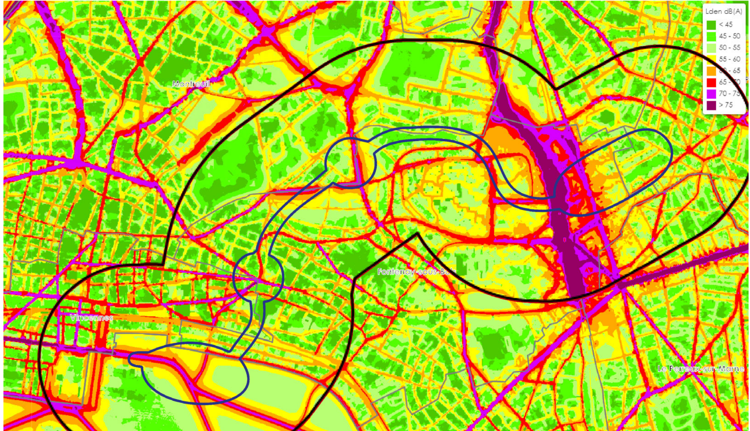
Figure 356 – Extrait de la carte des niveaux sonores routier représentant l'indicateur de bruit Lden sur une journée complète (2017) (Source : Bruitparif)
