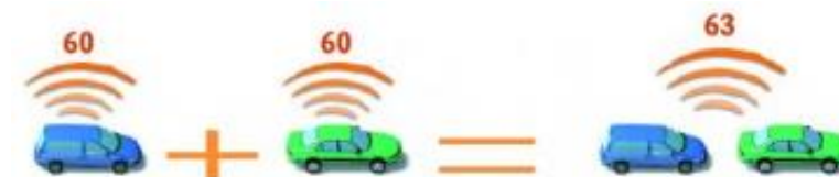
Figure 342 – Addition de deux sources sonores de même intensité (Source : Bruitparif)
