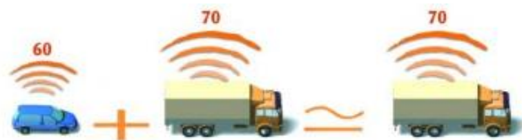
Figure 344 – Schéma de l'effet de masque (Source : Bruitparif)
