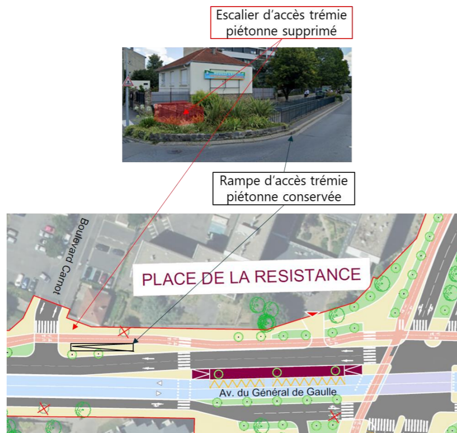
Figure 265 – Modifications du projet BBM apporté sur l'ouvrage de la trémie piétonne franchissant l'ex-RN34 : suppression de l'escalier d'accès et conservation de la rampe côté Nord
