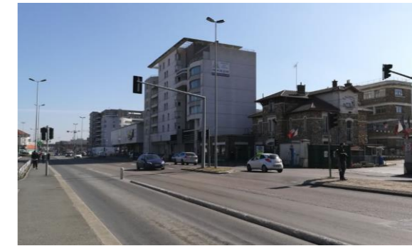
Boulevard Gallieni (ex-RN34) – Neuilly-sur-Marne Site propre unidirectionnel latéral dans le sens vers Paris Source : Egis, 2021
