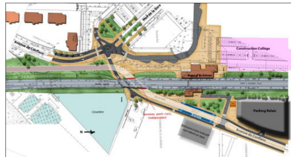
**Figure 110 : Variante B1 - Station tram-train positionnée à l'Est, au droit de la sortie de la gare d'Achères avec création d'un nouvel ouvrage de franchissement des voies indépendant de celui existant**
