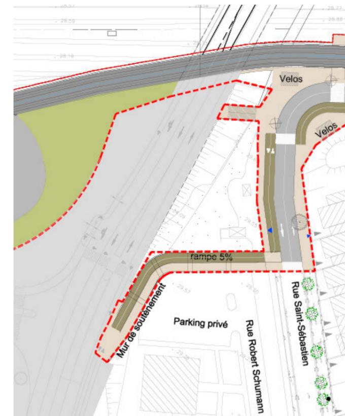
Figure 96 : Vue en plan du tracé sur la voie en tiroir
