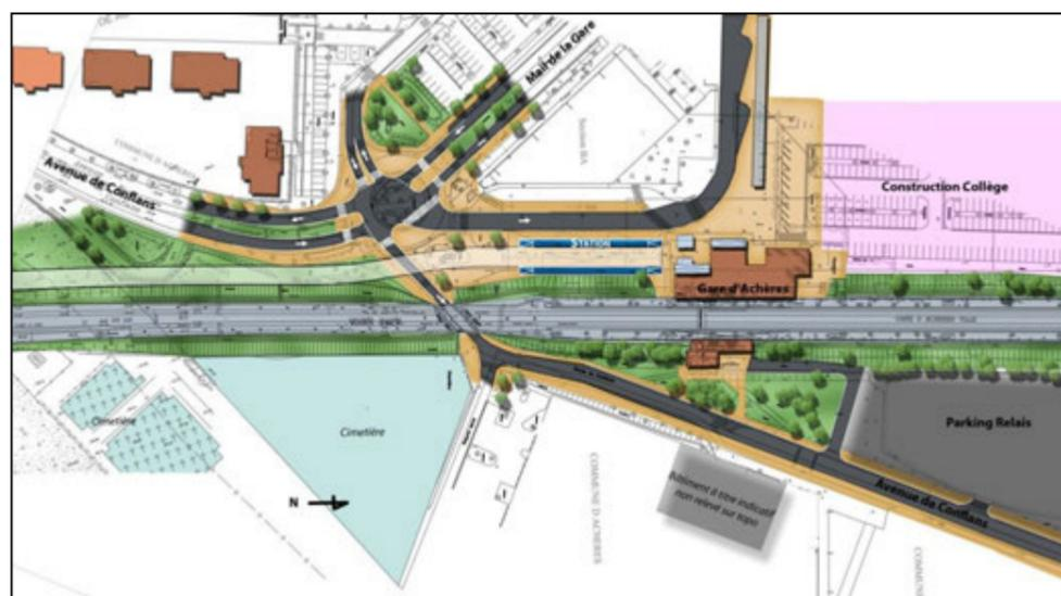
Figure 105 : Variante A1 - Station tram-train positionnée à l'Ouest, au droit de la gare d'Achères, avec quais latéraux
