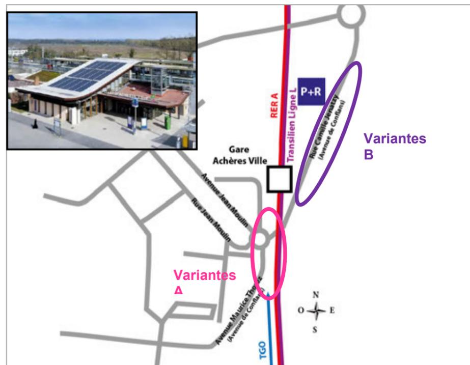
Figure 104 : Variantes de positionnement de la station d'Achères Ville à l'ouest ou à l'est des voies ferrées
