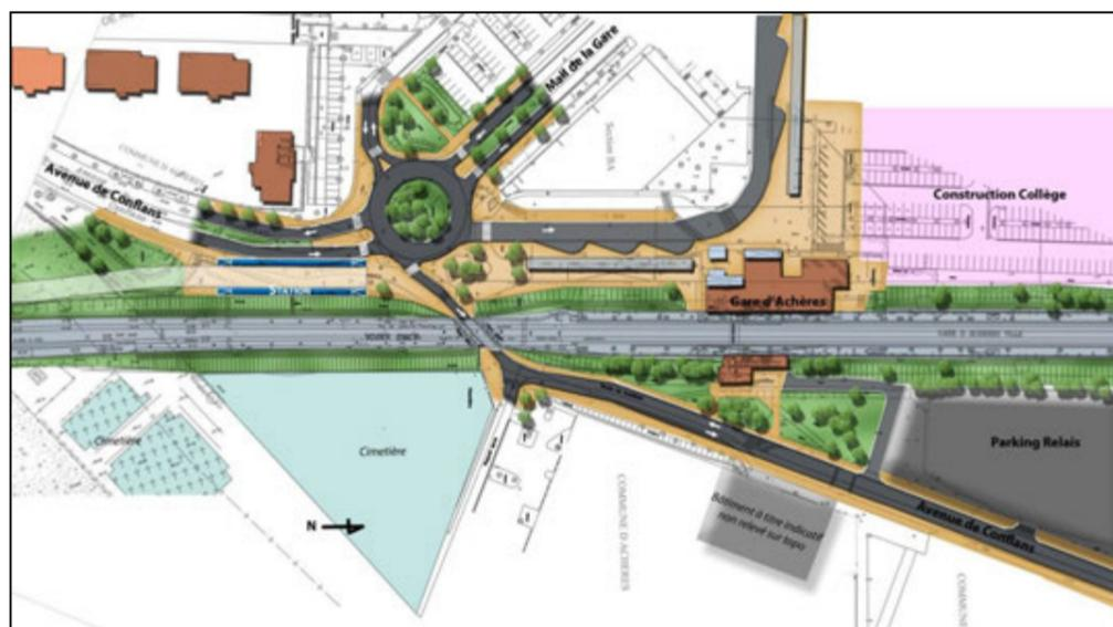
Figure 107 : Variante A2 - Station tram-train positionnée à l'Ouest, avant le carrefour
