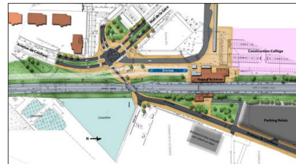
Figure 106 : Variante A1 bis - Station tram-train positionnée à l'Ouest, au droit de la gare d'Achères, avec quai central
