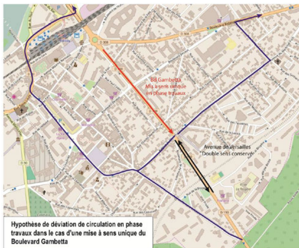
Figure 9 : Schéma de principe sur la gestion de la circulation en phase travaux sur l'avenue Gambetta
