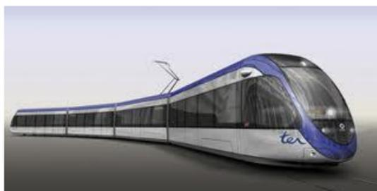
Figure 4 : Matériel roulant envisagé : le tram-train de type Dualis d'ALSTOM
