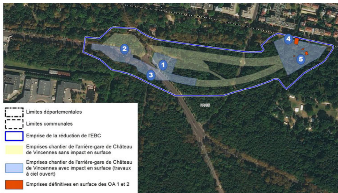
Figure 20 – Vue aérienne du couvert végétal des emprises du prolongement de la Ligne 1 et localisation des photos présentées ci-après : 1 : base vie ; 2 : raccordement sud ; 3 : raccordement sud ; 4 : poste de redressement (OA 1) ; 5 : grilles et trappes de l'OA 2 (source : IDFM)
