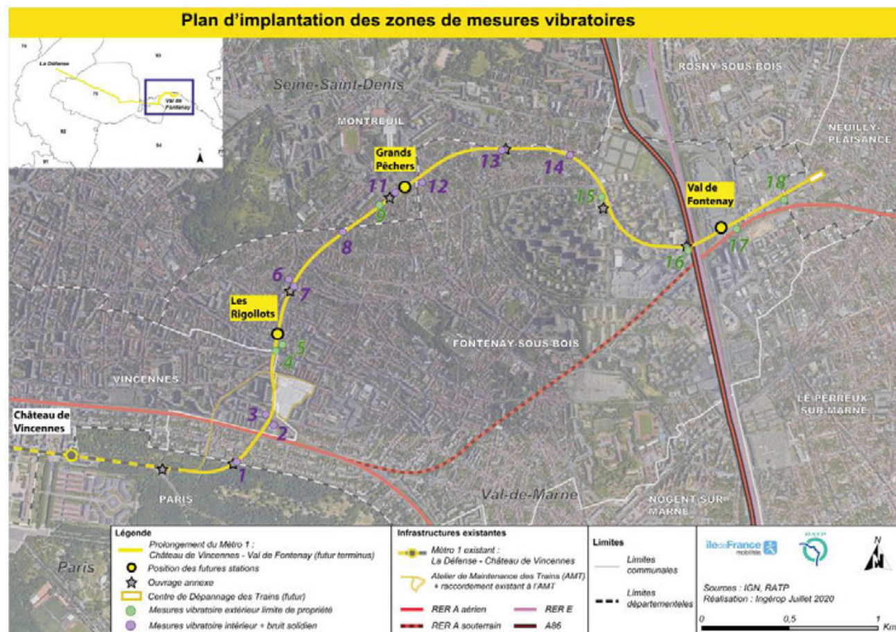
Figure 153 – Plan d'implantation des mesures in situ de l'état initial vibratoire de l'aire d'étude (Sources : RATP/Ingerop)
