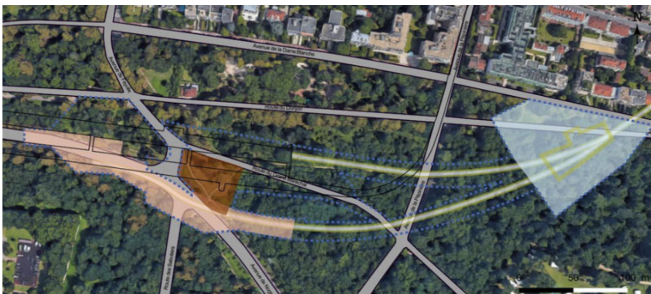
Figure 19 – Emprise chantier pour le raccordement du projet à l'existant (Sources : RATP / INGEROP – EGIS 2020)
