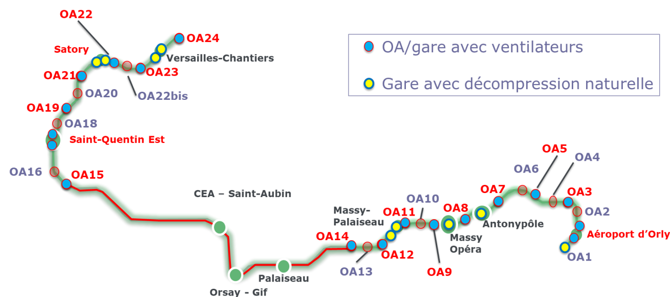
Figure 27 : Schéma de distribution des usines de ventilation en OA et gares
