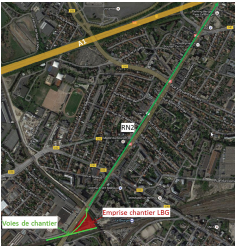
Figure 41 - Représentation de schéma de circulation d'évacuation des déblais par la RN2
