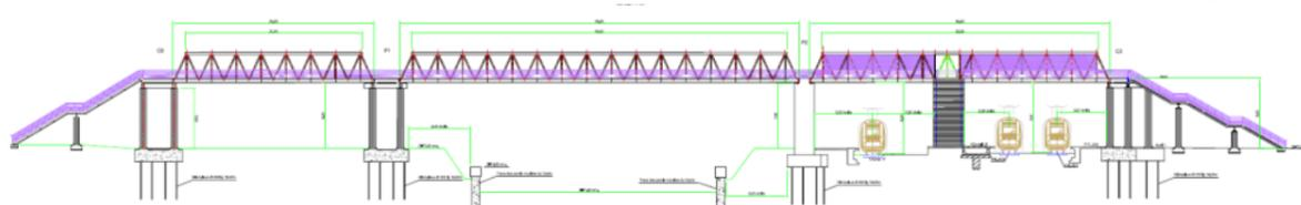
Figure 87: Gare de Fort d'Issy Vanves Clamart – coupe en long sur la passerelle d'accès
