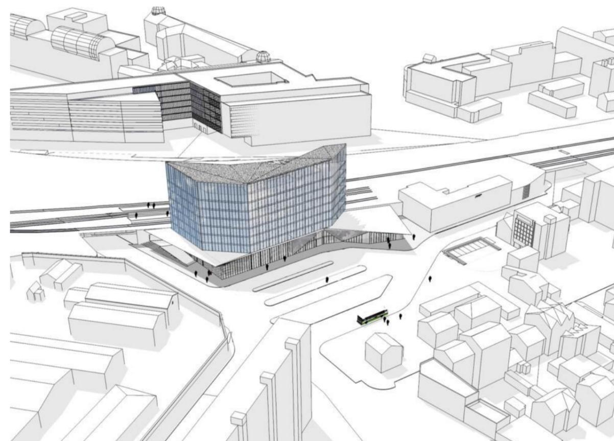
L'ensemble du bâtiment est organisé selon une trame fonctionnelle de 1.35 mètres qui ordonne l'implantation des éléments de structure, le compartimentage, etc. La rationalisation de la trame permet une plus grande flexibilité dans l'aménagement des espaces intérieurs.
