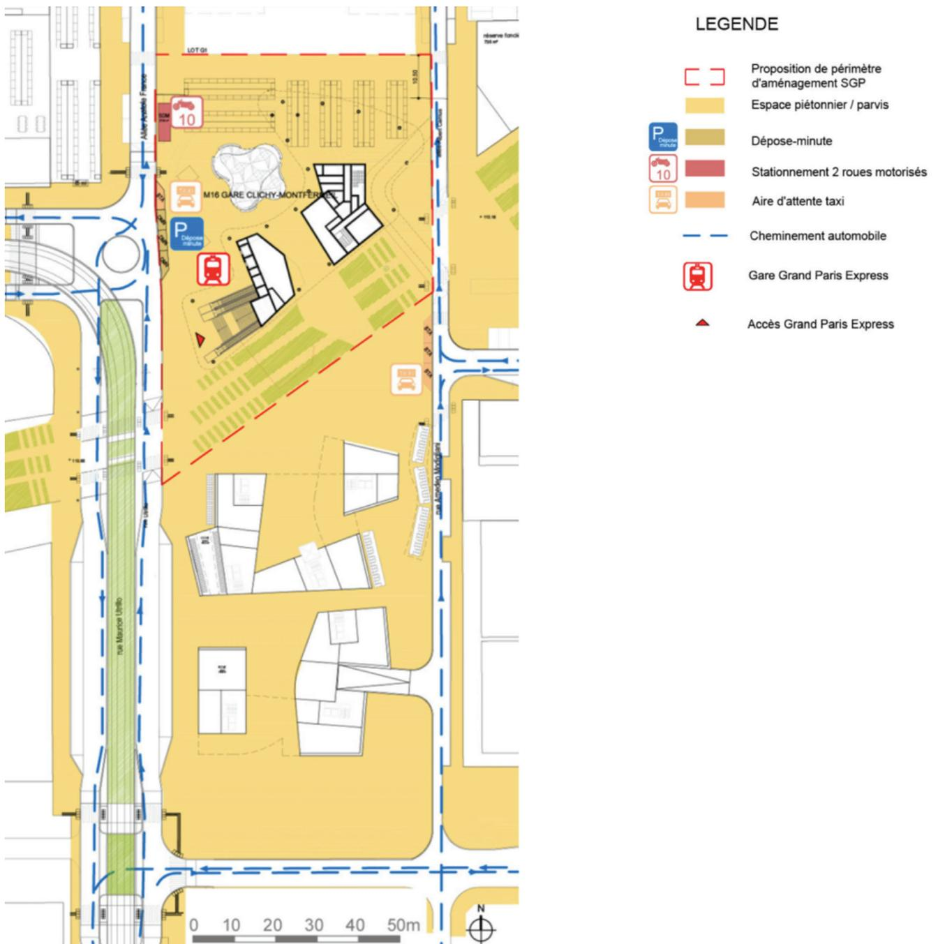
Figure 19 - Plan des modifications prévues pour les places de stationnement
