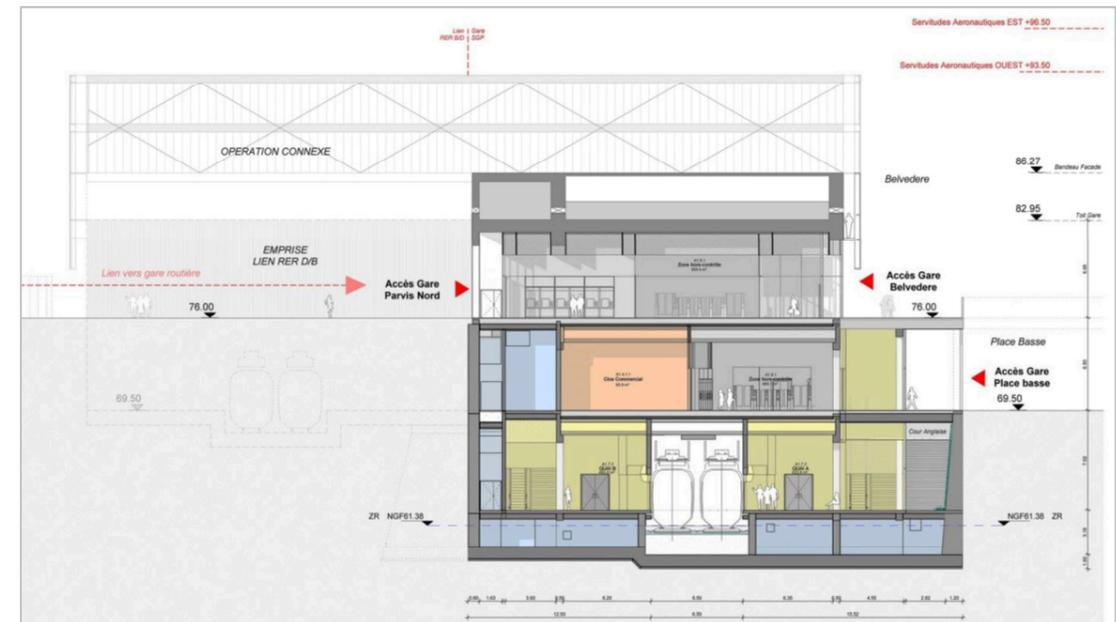
Figure 61 : Vue en coupe de la gare TDG avec les limites des servitudes aéronautiques
