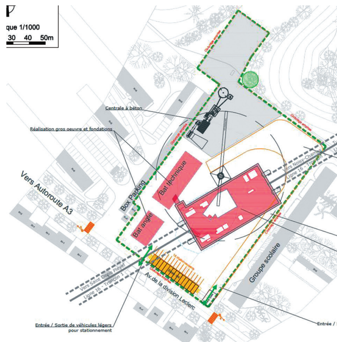
Figure 36 - Le Blanc Mesnil - Phase de réalisation de la dalle de couverture et GOE des bâtiments technique et d'angle.
