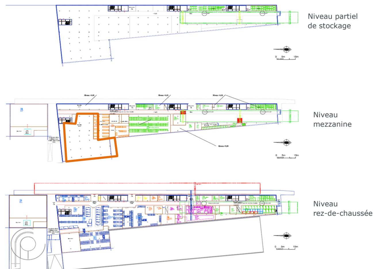
Figure 68 : Plan d'aménagement des stockages et ateliers de maintenance de l'infrastructure
