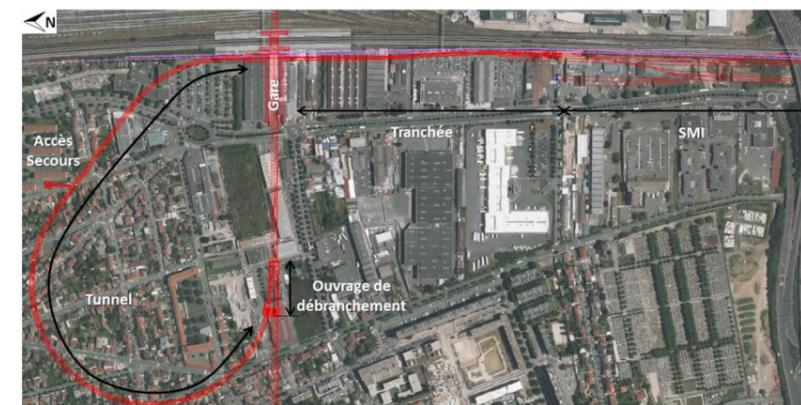
Figure 14 : Insertion en plan du raccordement au SMI
