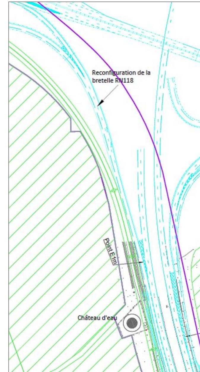
Figure 64 : Implantation viaduc au droit du château d'eau
