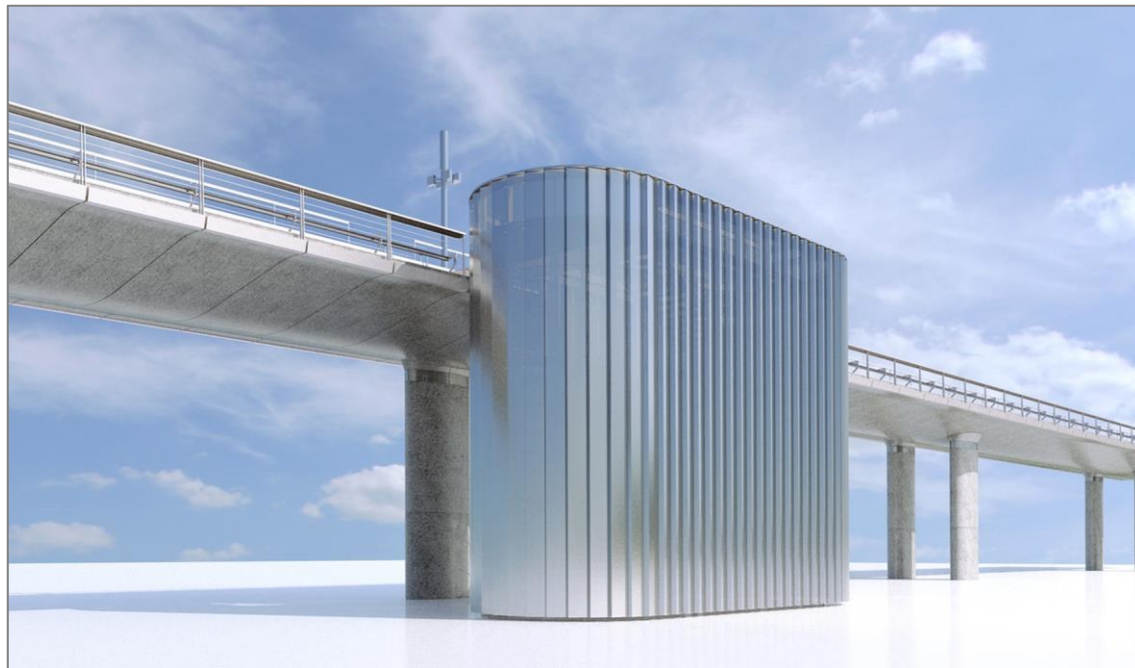
Figure 58 : Perspective des escaliers de secours en évacuation latérale – Explorations architecture, Mars 2017
