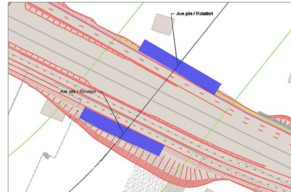
Figure 68 : Construction des fléaux, orientés parallèlement à la RN118
