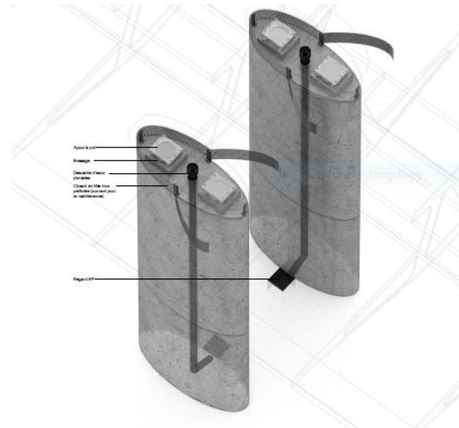
Figure 53 : Evacuation des eaux zénithales par un réseau à l'intérieur des piles du viaduc-Exploration architecture, mai 2019
