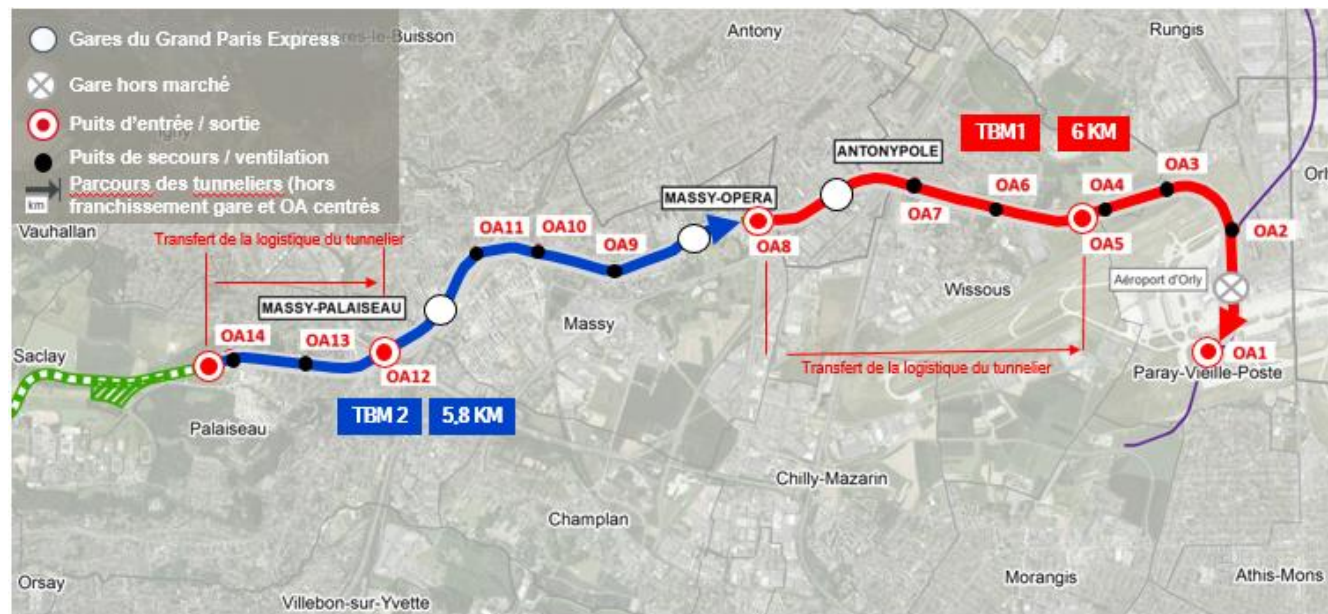
Figure 14 : Cinématique des tunneliers partie Est
