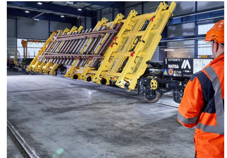
Exemple d'un wagon « pupitre » permettant d'acheminer les parties d'aiguillages déjà assemblées
