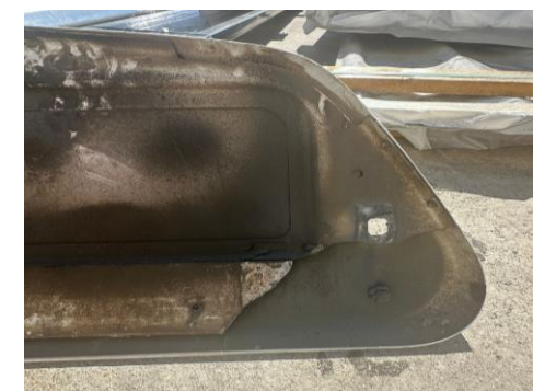
Jupe version initiale avec double peau détériorée
