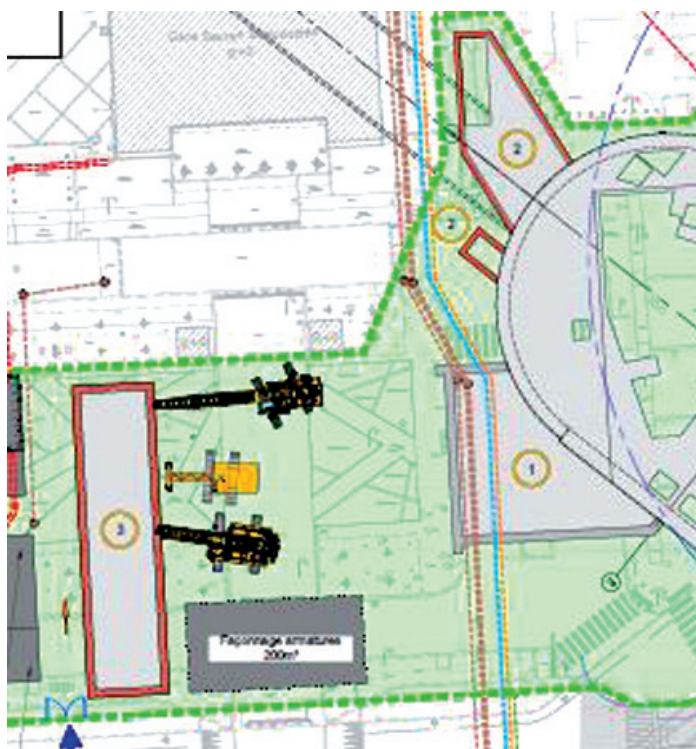
Figure 21 - Phase de construction des excroissances côté ouest (zone SNCF)
