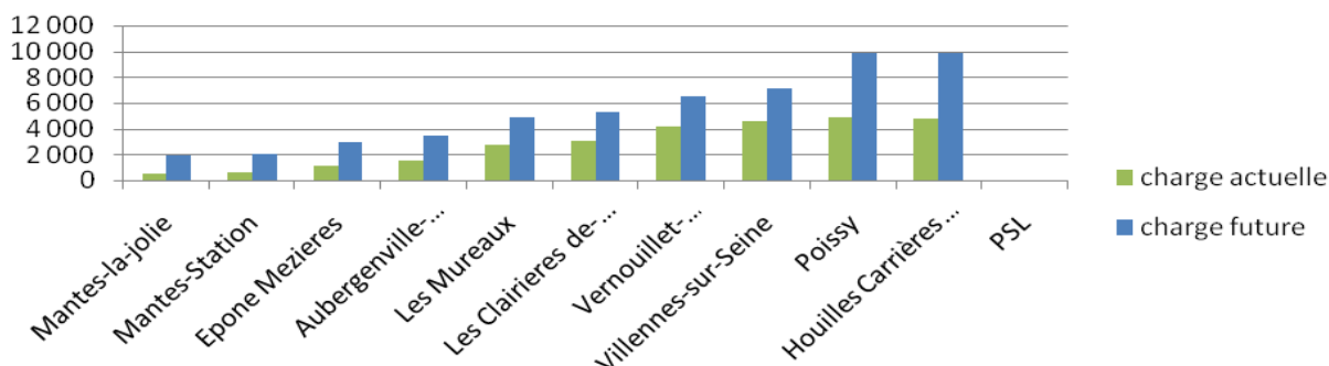
Graphique 2 – serpent de charge de la ligne du RER E à partir de la gare de Mantes-la-Jolie
