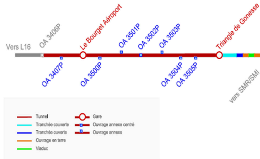
Figure 36 : Représentation synoptique des ouvrages annexes du secteur 1 de la ligne 17 Nord.
