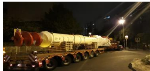
La Dhuis : Acheminement des éléments du tunnelier par convoi exceptionnel (Visse d'extraction)
