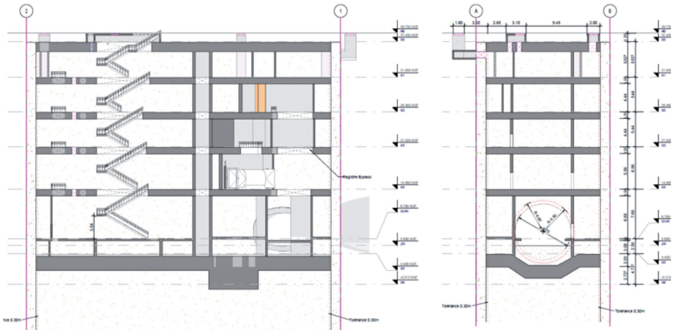
Figure 75 – Coupes du puits OA 332
